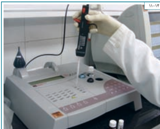
اندازه گیری فاکتور های انعقادی ( فاکتور ۸، فون ویلبراند، فیبرینوژن) با استفاده کوآگولومتر کالیبره
