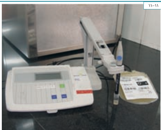
pH پلاکت را با pH سنج کالیبره اندازه گیری می کنیم.
