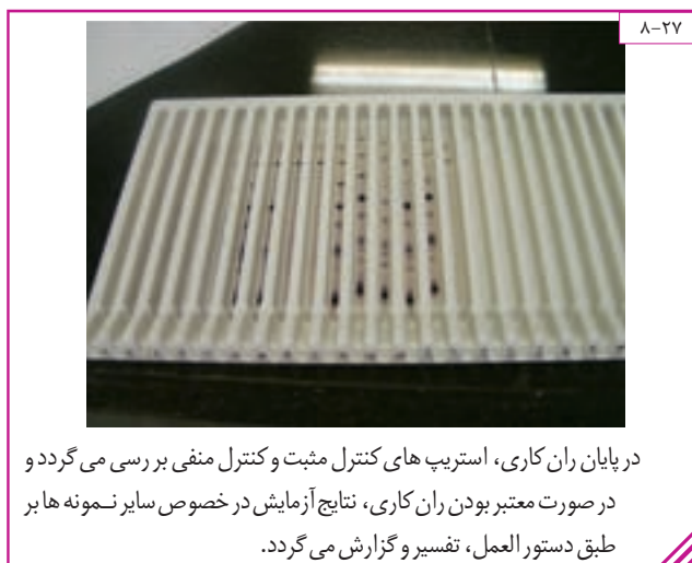
پس از مدت زمان تعیین شده در بروشور کیت کنترل های مثبت و منفی و نمونه ها به ناودان های مشخص شده، اضافه می شود. بقیه مراحل (افزودن سایر معرف ها و مرحله های انکو باسیون) به طور خودکار توسط دستگاه انجام می شود.
